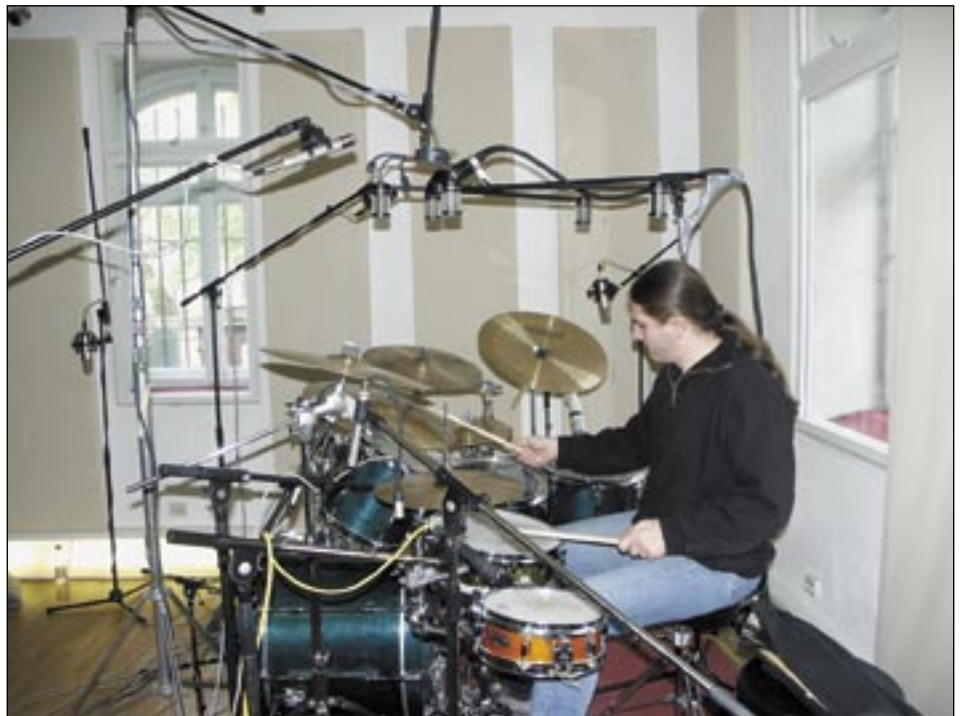
Mikrofonsetup für Studiodrummer Michael Joch mit Brauner-Spinne ASM 5 und Stützmikrofonen
